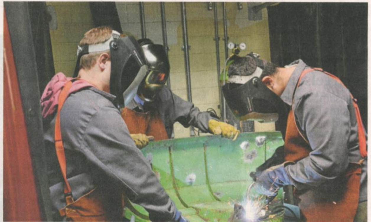
In der Berufsschule II in Gifhorn lernen Auszubildende das Schweißen eines Kotflügels.
